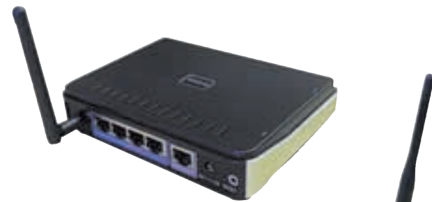
Foto 2. Para remover a antena de 2dBi, é só desrosqueá-la.
