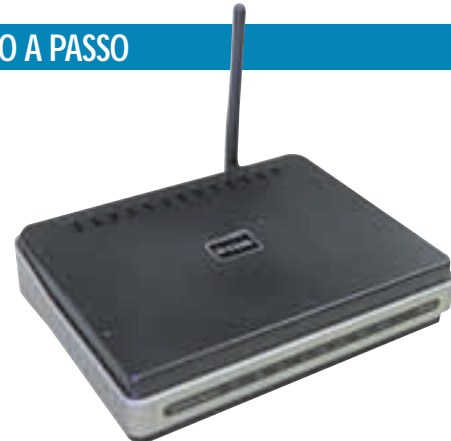
Foto 1. Roteador wireless de 15dBm (potência de transmissão) e antena de 2dBi.
